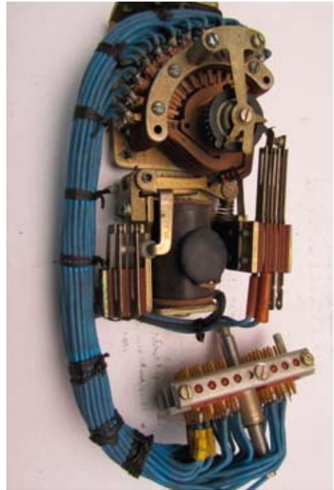
Armadio elettrico CG 160 2 T, pulsantiera con programmatore a spine e selettore rotativo, 1966.
