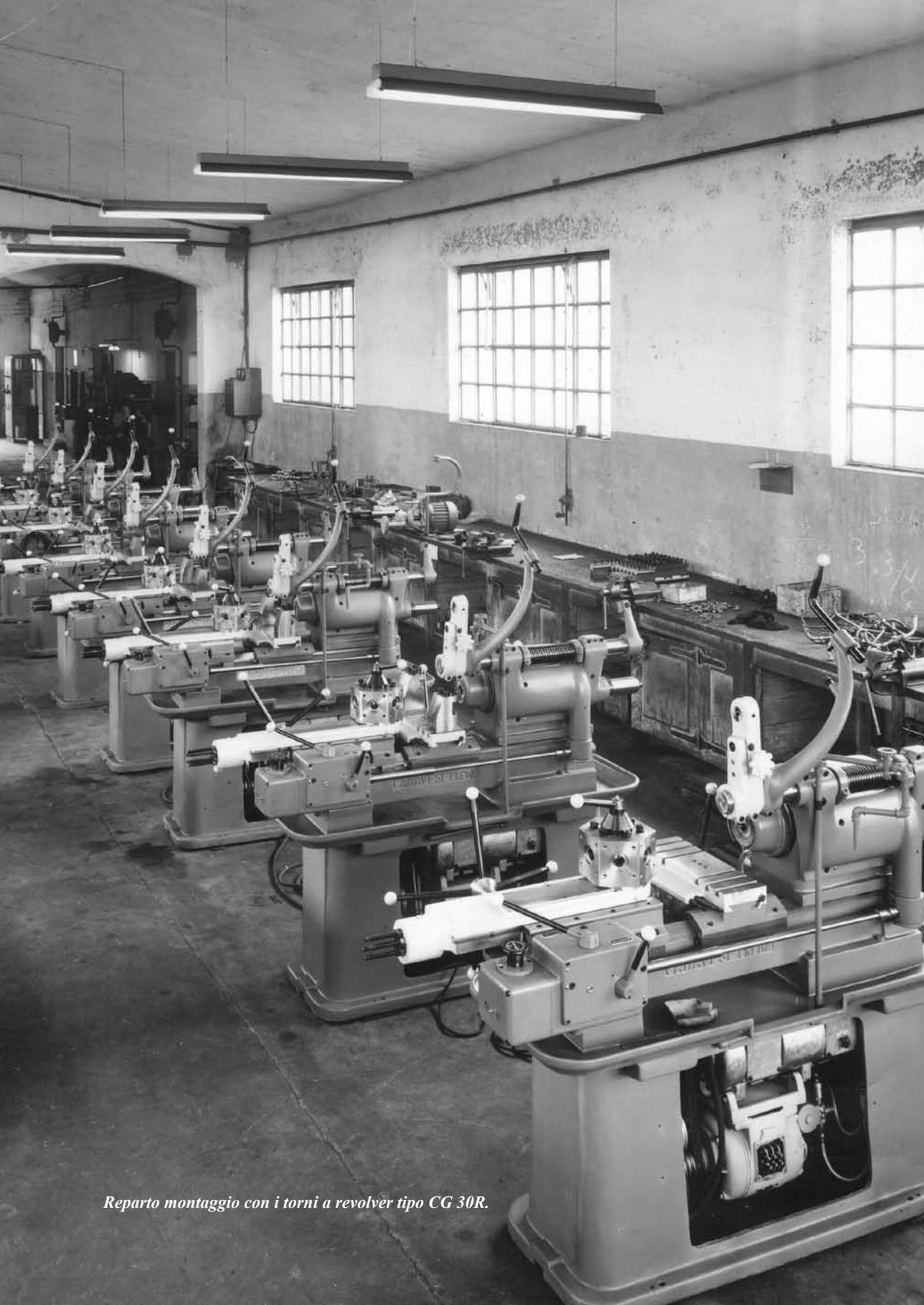
*Reparto montaggio con i torni a revolver tipo CG 30R.*
